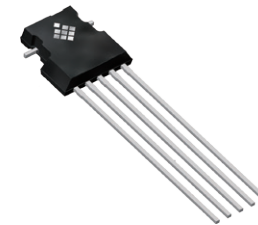
HAC37xy使用被称作像素单元的水平(BZ)和垂直(BX、BY)霍尔片,实现了多轴磁性测量
